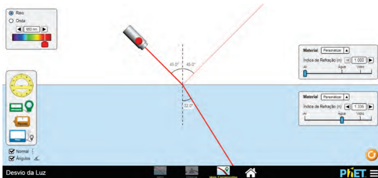
Figura 1 – Reflexão e refração da luz quando incide em uma superfície que separa dois meios.
