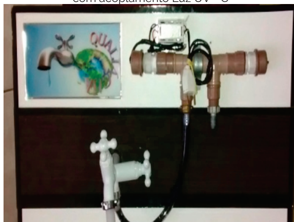
Figura 4 – Filtro de Carvão Ativado com acoplamento Luz UV - C
