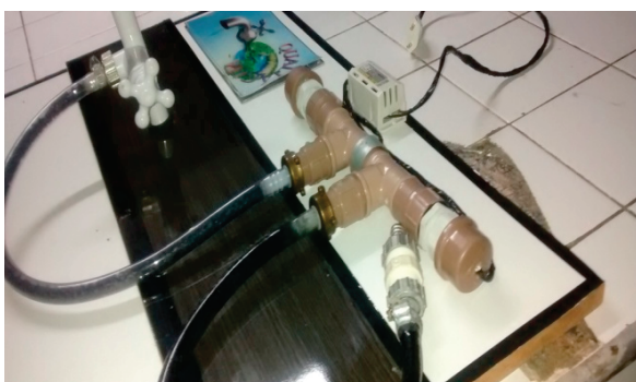
Figura 5 – Filtro "Qualiágua" com o acoplamento Carvão Ativo do Coco Verde e Filtro UV
