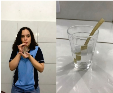
Figura 06 – Teste de sucção e de durabilidade do canudo na água com duração de 20~30min.
